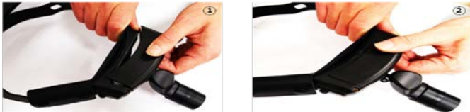
그림 3.1 배터리 팩 조립 방법
