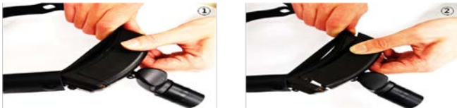
그림 3.2 배터리 팩 분리 방법
